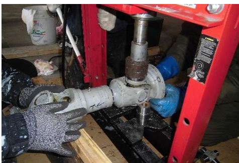
(クロスベアリング交換作業)
